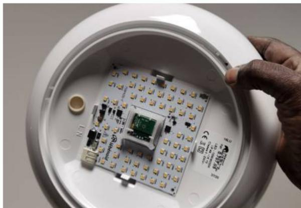
"Je vous montre ici un hublot intelligent dans les escaliers du lycée, on était souvent dans le noir quand on ne trouvait pas le bouton poussoir pour allumer l'ensemble des 7 blocs néons et aujourd'hui je les ai remplacés par cet hublot Led de 10 watts qui possède un détecteur de présence. La lumière s'allume seulement au passage des personnes. Tout ça sur trois niveaux et dans 5 cages d'escaliers !"
